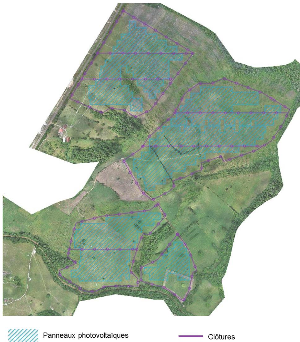
Figure 8. Plan d'implantation des panneaux photovoltaïques
