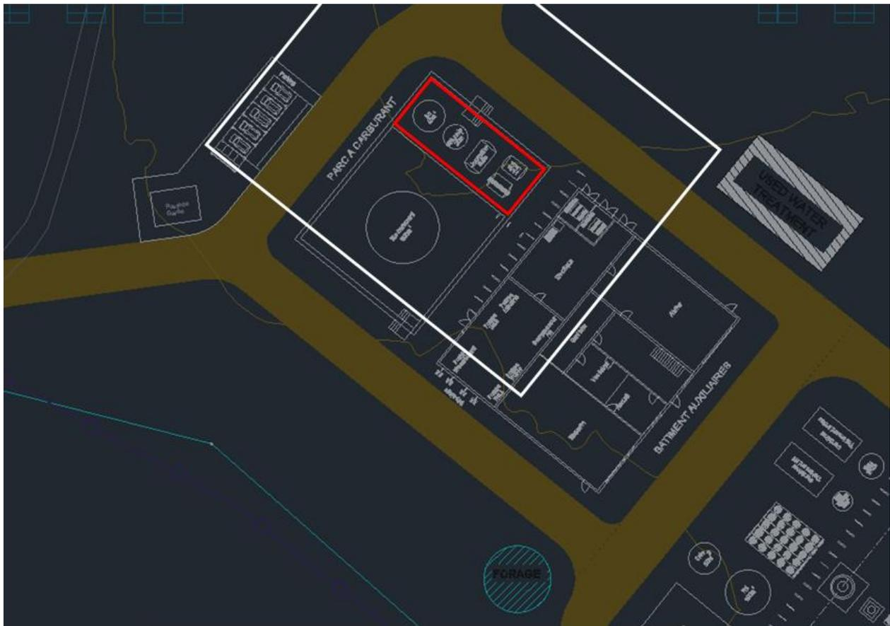
Figure 23. Périmètre des effets dominos thermiques (en blanc) générés par un feu de nappe de diesel
